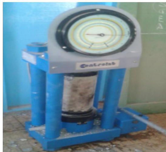
Figure 7: éprouvette de béton sous la presse manuelle prêt pour l'écrasement de béton
