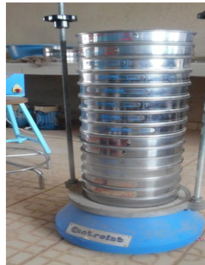
Figure 6: une série de 15 tamis sur une tamiseuse utilisée pour l'essai d'analyse granulométrique
