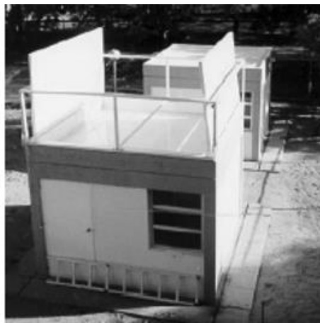
Figure 3 : Cellule test avec un toit protégé [Rincón et al., 2000]
